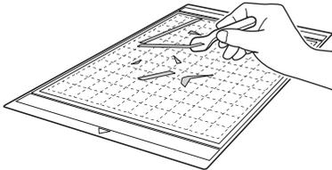
Entfernen Sie mit einer handelsüblichen Pinzette Stofffäden, die an der Matte angebracht sind.
