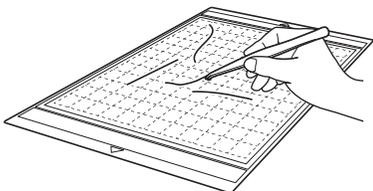
Reinigen Sie die Punktmarkierungen auf der Matte und den umgebenden Bereich mit einem trockenen Tuch.
