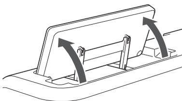
Um das Bedienfeld vollständig einzuklappen, heben Sie es zuerst an, bis es senkrecht steht. Anschließend lässt sich das Bedienfeld vollständig einklappen. Wenn Sie den Winkel des Bedienfelds verringern möchten, heben Sie es an, bis es senkrecht steht, und stellen Sie dann den Winkel wieder ein.
