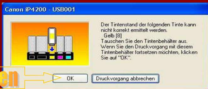
Ein komplett leergedruckter, refillter oder kompatibler Tank wurde eingesetzt. Der Drucker merkt durch die Chipinfo, dass da was nicht stimmt....
