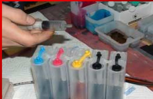
Halten Sie das Schlauchende über einen Behälter und geben sie langsam etwas Luft in den Tintenbehälter. Nun sehen Sie, wie der Schlauch sich mit Tinte füllt.
