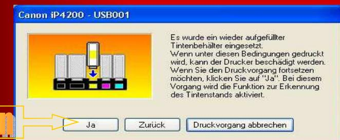
Nach dem Klick auf **OK** weist er darauf hin, dass kein Originaltank eingesetzt wurde.
